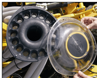
Figure N°23 : Tête de répartition
