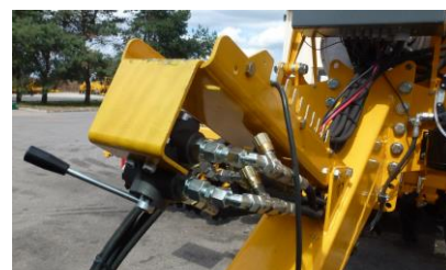
Figure : 2 : Vanne d'orientation du flux (traceur - loquet de verrouillage)
