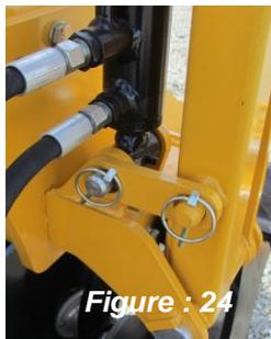
Les traceurs à commande hydraulique pénètrent alternativement à droite et à gauche dans le sol. Ainsi, le semoir en mouvement produit une marque. Cette marque aide le conducteur du tracteur à s'orienter et à effectuer un raccord correct après le demi-tour en bout de champs.
