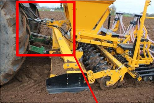
Le capteur de distribution permet de couper automatiquement la distribution lorsque le semoir est levé en bout de champs.
