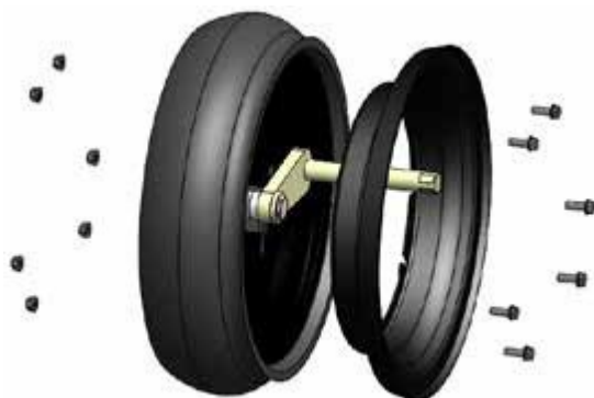
Aktivní stěrka montovaná na stírací kolo
