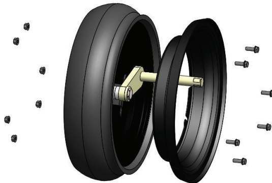
Metallumreifung auf Seitenrad montiert
