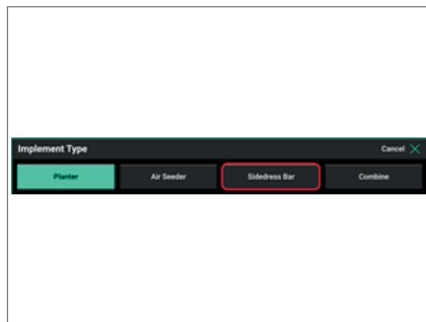
Au moment de la publication de ce document, lorsqu'on change de type d'outil, les configurations des autres types d'outils (semoirs, par exemple) sont automatiquement réinitialisées à leurs valeurs par défaut. Il existe deux façons possibles de sauvegarder ces configurations avant de changer de type d'outil.
