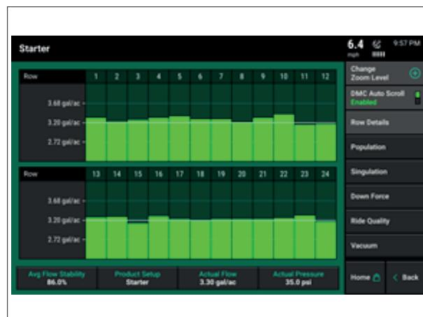
Au bas de cette page apparaissent la stabilité du débit moyen du semoir (Planter Average Flow Stability), la configuration du produit (Product Setup), le débit en temps réel (Actual Flow) et la pression en temps réel (Actual Pressure).
