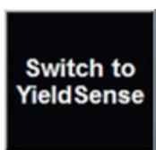
Appuyer sur Passer à YieldSense (Switch to YieldSense) sur le côté droit de l'écran. Le logiciel passe alors dans le mode de récolte qui permet d'utiliser le système YieldSense.
