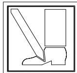
При опускании машины выдерживайте безопасное расстояние до машины. Опасность серьезных травм.
