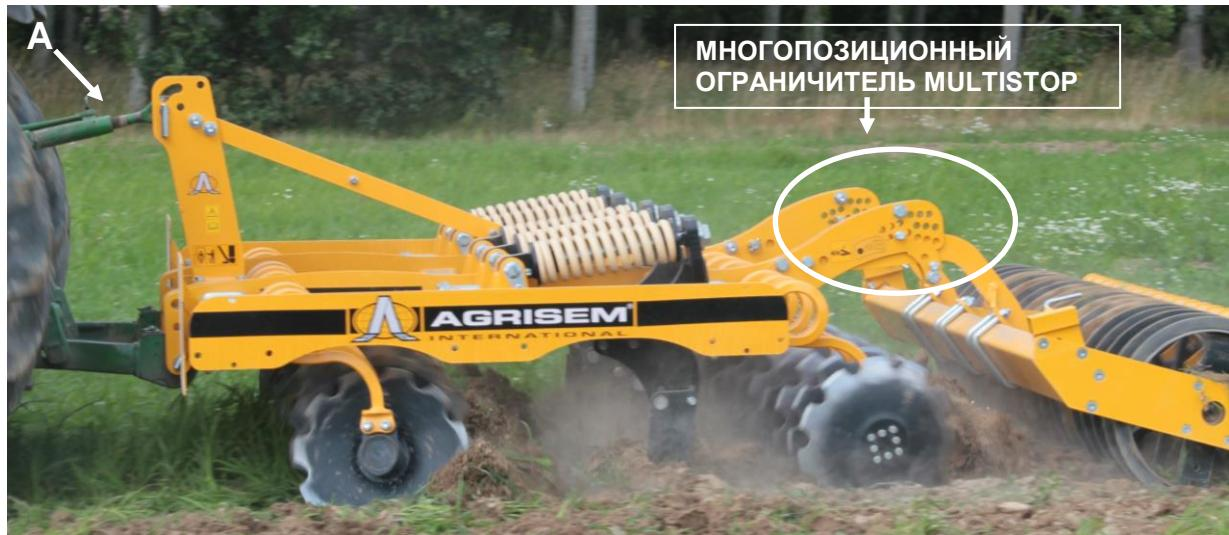
Наклон агрегата во время работы регулируется верхней тягой "A". Многопозиционный ограничитель компании AGRISEM позволяет регулировать рабочую глубину с помощью катка.
