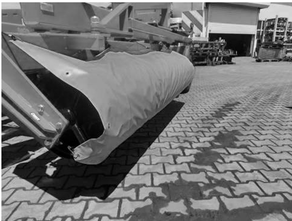
Zdjęcie nr 1. Oslona z plandeki na zewnętrzne elementy maszyny - strona prawa wału.
