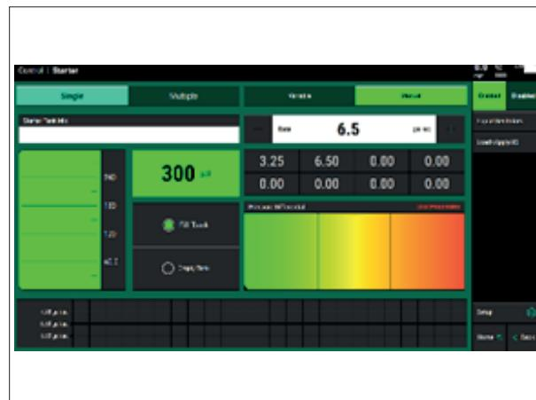
Appuyer sur le bouton Modulation selon MO (OM Control) ; l'écran de contrôle des densités/dosages variables du SmartFirmer apparaît comme illustré ci-dessous. Pour activer ou désactiver la modulation en temps réel, appuyer sur le bouton de commande Toutes DV selon MO (All OM VR) sur la droite de l'écran.
