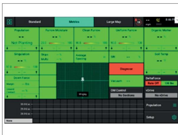
Le bouton Modulation selon MO (OM Control) permet d'afficher l'écran de contrôle des densités (ou dosages) variables du système SmartFirmer. Pour activer ou désactiver la modulation en temps réel, appuyer sur le bouton de commande Toutes DV selon MO (All OM VR) sur la droite de l'écran. (Sur l'écran affiché ci-contre, la fonction de modulation selon MO est activée.)
