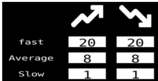
Ces réglages correspondent aux accélérations et ralentissements du moteur en fonction de l'écart de la régulation.
